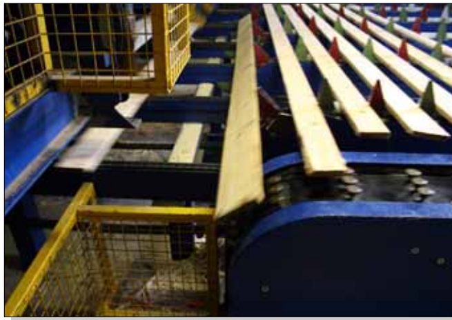
Übergabe von Hai-Flossen-Kette an den Sortierförderer
