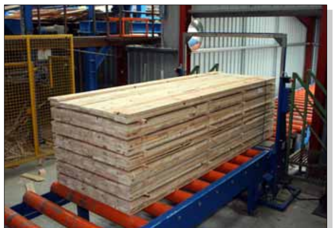
Umreifung der fertigen Pakete
