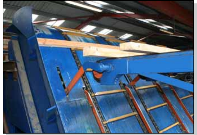
Die Übergabe der Hauptware erfolgt auf den in der Neigung veränderbaren Vereinzler vom oberen und der Seitenware vom unteren Deck
