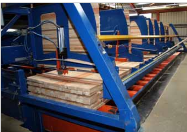
Pneumatische Lattenmagazine: schnell und präzise
